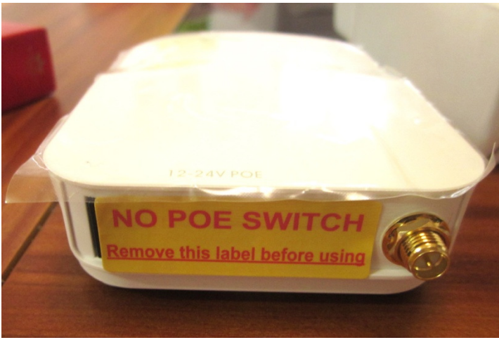
Mặt sau thiết bị có dán bảo vệ 2 cổng Ethernet (Data, PoE) & nguồn.
