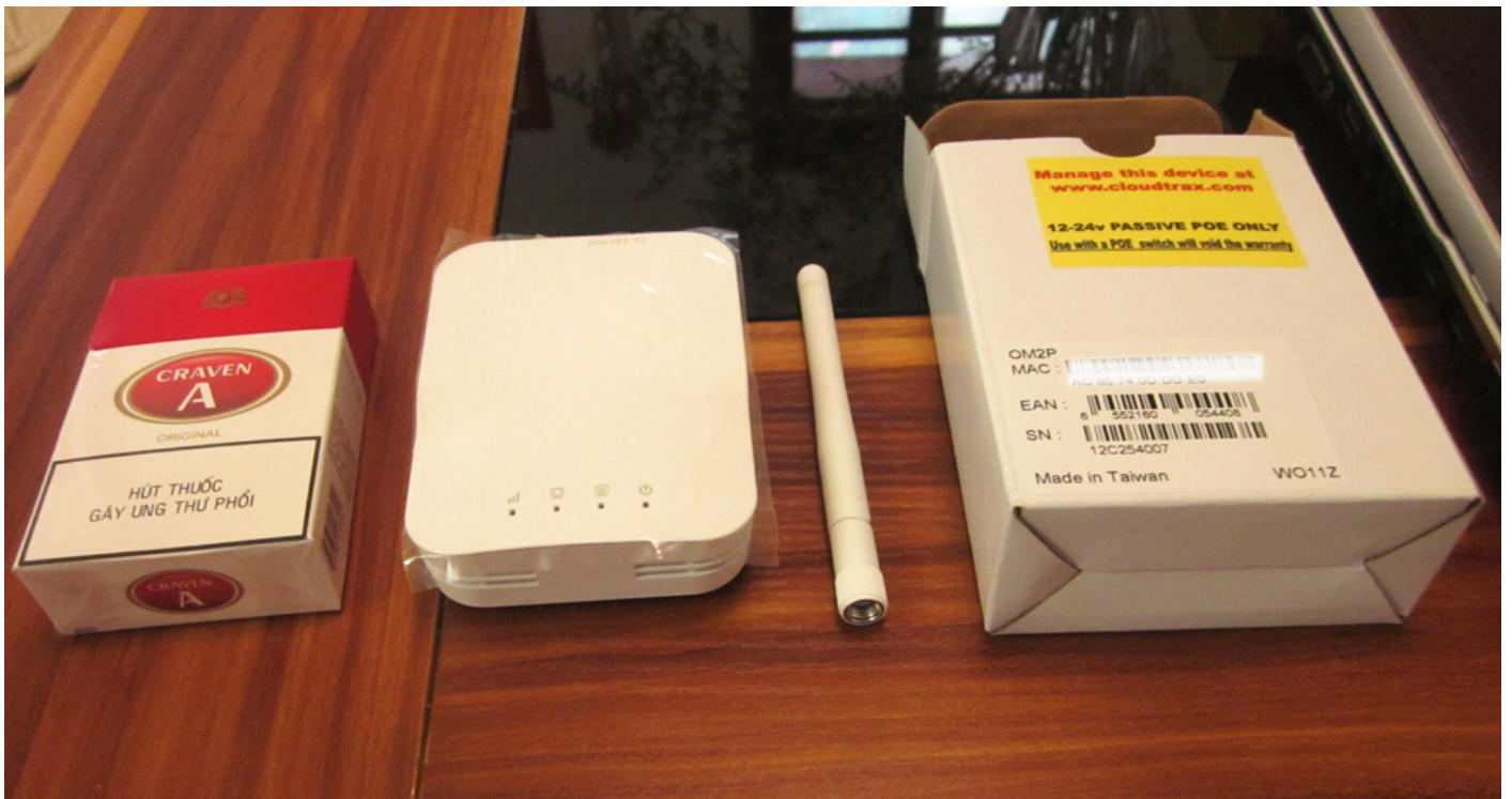
Thiết bị bên trong bao gồm: OM2P và Anten. Các thiết bị OM2P-HS và OM2P-LC không có anten.
