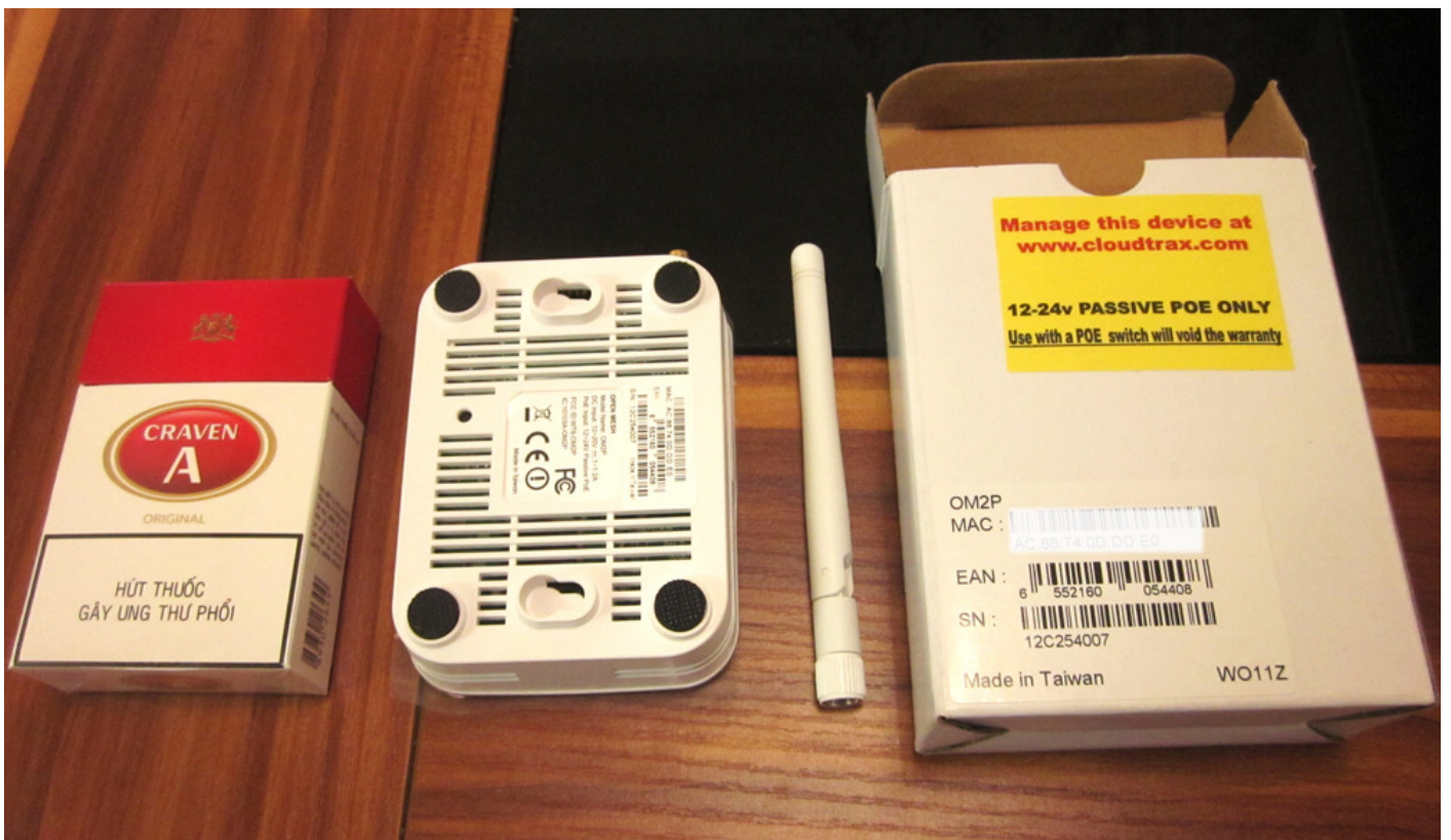
Mặt sau thiết bị có các khe tản nhiệt và nhãn thông số thiết bị trùng khớp với các thông số trên hộp giấy.
