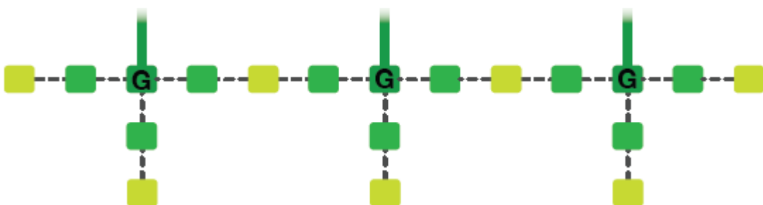
Sơ đồ bố trí 16 node hops (repeaters) & 3 node gateways (gateways) tối ưu với khả năng phủ 80 Ha (outdoor)
